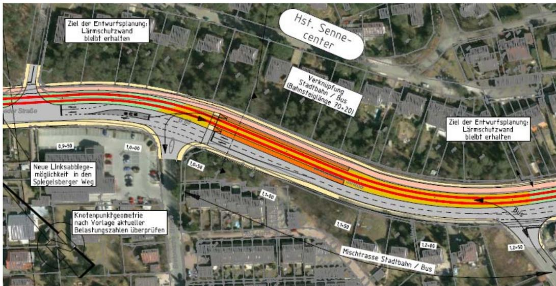
Abbildung 23: Haltestelle Senne-Center mit Mischnutzung Stadtbahn/Bus
